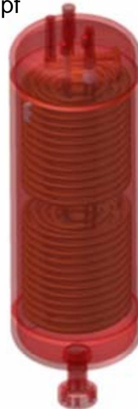
Durch Brugg lieferbar: Wärmetauscherkopf, Erdschutzfuß
