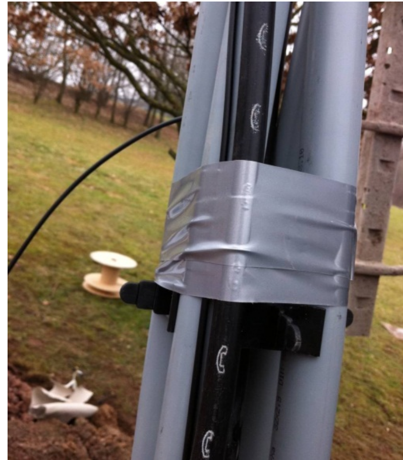
Installation des DTS, Pt100-Kette und Abstandshalter
